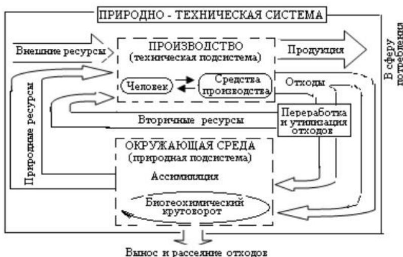
Рис. 2. Схема материальных потоков в ПТС.
